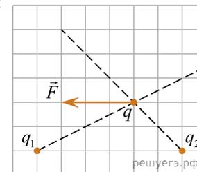
37. На точечный заряд  $q$ , находящийся в электростатическом поле, созданном зарядами  $q_1$  и  $q_2$ , действует сила  $\vec{F}$  (см.рис.). Если заряд  $q_1 = 5,8$  нКл, то заряд  $q_2$  равен ...нКл.
