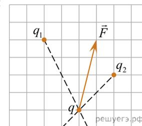
36. На точечный заряд  $q$ , находящийся в электростатическом поле, созданном зарядами  $q_1$  и  $q_2$ , действует сила  $\vec{F}$  (см.рис.). Если заряд  $q_1 = -48$  нКл, то заряд  $q_2$  равен ...нКл.
