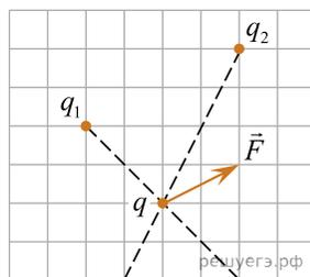
38. На точечный заряд  $q$ , находящийся в электростатическом поле, созданном зарядами  $q_1$  и  $q_2$ , действует сила  $\vec{F}$  (см.рис.). Если заряд  $q_1 = 17$  нКл, то модуль заряда  $q_2$  равен ...нКл.
